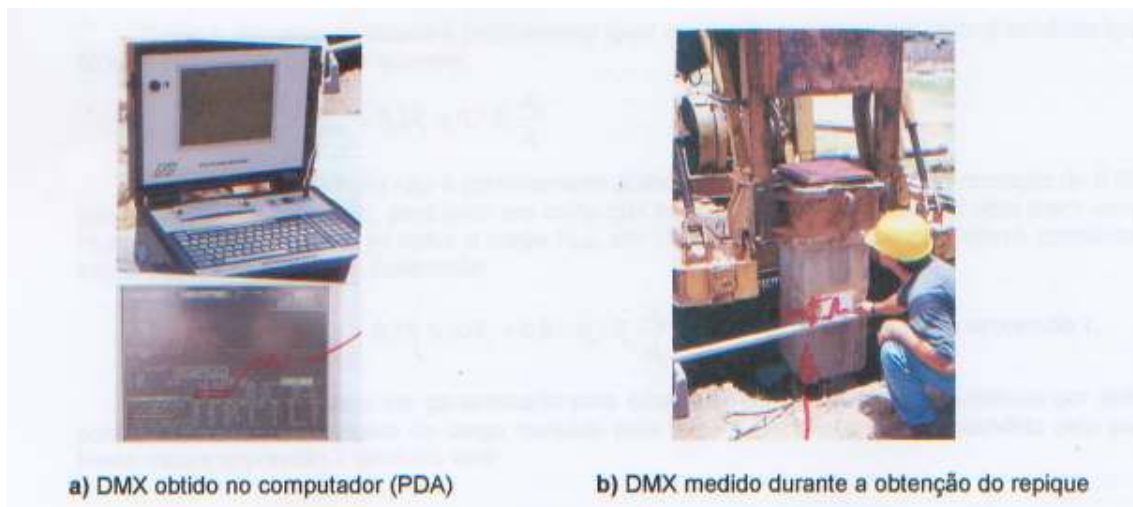
Figura 7 – Aferição dos parâmetros do ensaio dinâmico pelo repique
